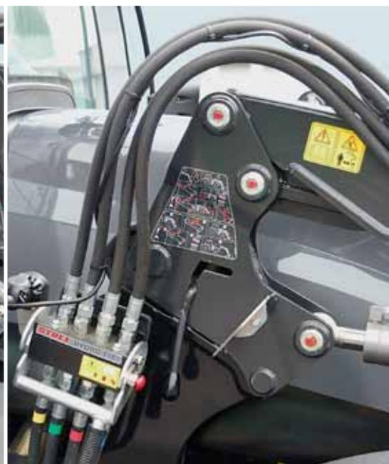
Einfach Einfahren und den Frontlader mit einem Handgriff sicher verriegeln.
