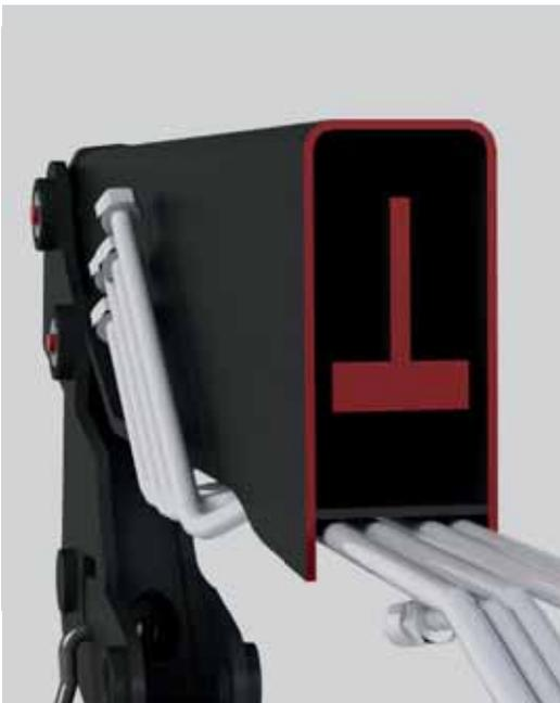
Jeder Holm des Frontladers wird aus einem Stück gebogen. Im Hohlraum befindet sich die Steuerstange, darunter die Hydraulikleitungen.
