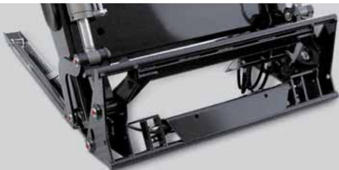
Die hydraulische Werkzeugverriegelung HYDRO-LOCK ist auf Wunsch lieferbar.
