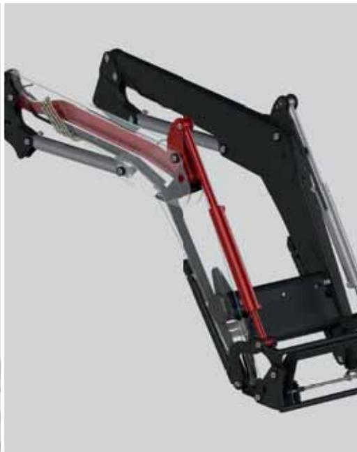
Hohe Hub- und Reißkräfte sind durch die robuste Z-Kinematik garantiert.
