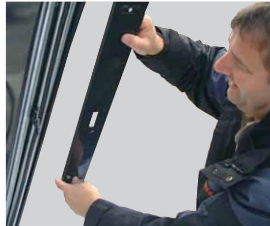
*Zur Kontrolle und Wartung der Leitungen kann das Schutzblech an der Unterseite der Schwingenholme schnell abgenommen werden.*
