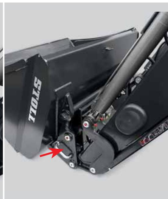
... das Verriegeln erfolgt automatisch beim Ankippen des Werkzeuges..
