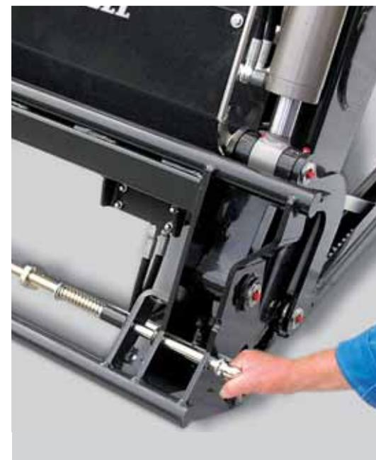
Die Bedienung der Entriegelung der Anbauwerkzeuge erfolgt sicher von der Seite.
