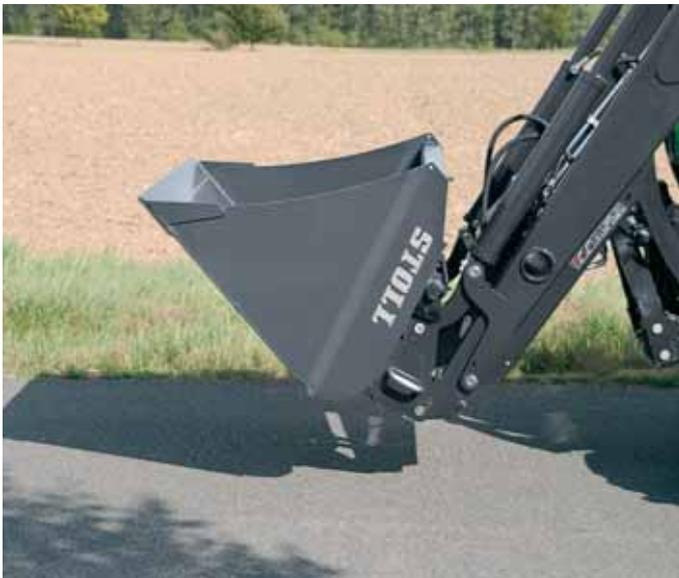
*Hervorragende Ankippwinkel: ECO 650/750: 43°. ECO 850/950: 46°.*
