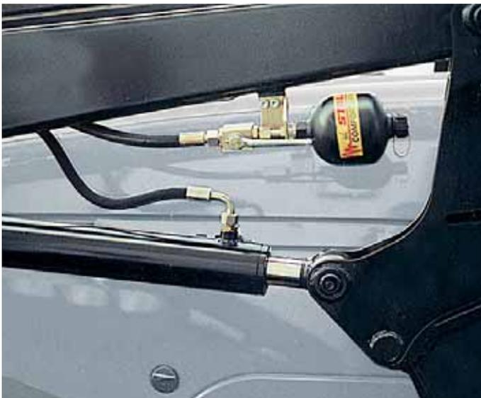
COMFORT-DRIVE: Verhindert Nickbewegungen des Traktors bei Transportfahrten mit angebautem Frontlader. Schont den Fahrer und den Traktor (auch nachrüstbar).
