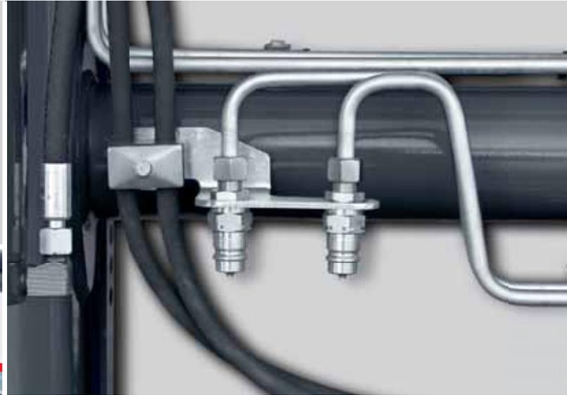
*Dritter Steuerkreis zur Bedienung hydraulischer Werkzeuge z. B. mit Greiffunktion
