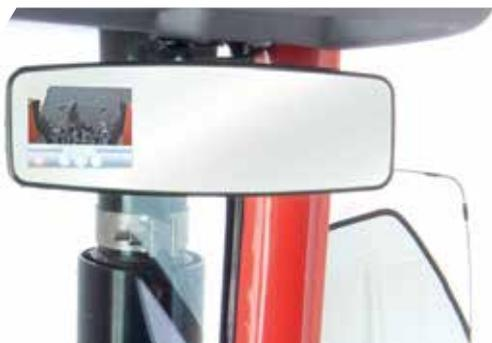
**Im IBC-Innenspiegel wird die Rückfahrkamera dargestellt**
