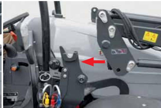
Mit wenigen Handgriffen wird der Frontlader zum Abstellen abgebaut. Per Steuergerät wird die Anbausäule aus dem Anbauteil herausgeschwenkt, die Abstützen herabgelassen und die Hydraulik abgekoppelt.
