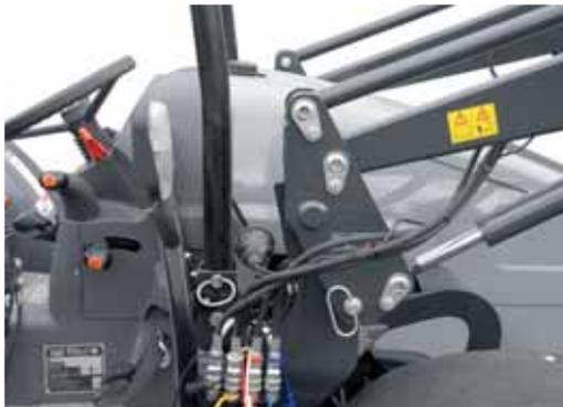
Lader und Traktor werden mit dem speziellen Einschwenksystem sicher miteinander verbunden. Die Abbildung zeigt den angebauten Frontlader mit den angeschlossenen Hydraulikverbindungen.
