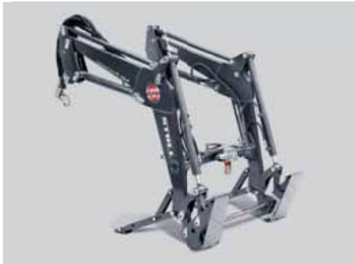
FC 350 P – mit mechanischer Parallelführung.
