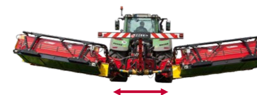
Hydraulische Seitenverschiebung der Förderbänder
