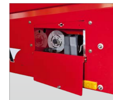
Integrierter Werkzeugkasten in der Deichsel
