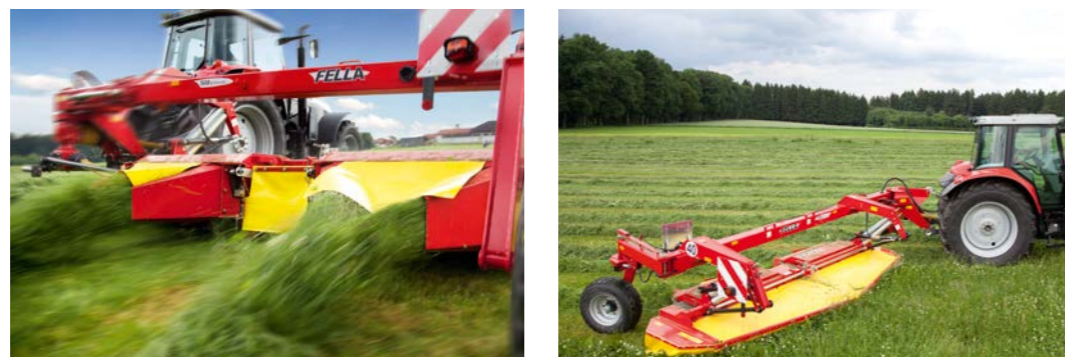
Randmähen (Schrägstellung Mähwerk 25°)
