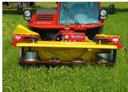
Vier Mähscheiben für symmetrisch mittigen Lauf
