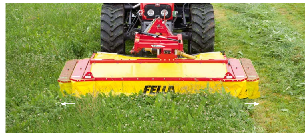
SM 260 FP-S: hydraulisch stufenlos seitlich verschiebbar (je ca. 20 cm)
