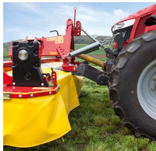
SM 310 FP-K extrem kompakter Anbau am Traktor
