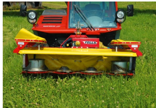
Vier Mähscheiben für symmetrisch mittigen Lauf
