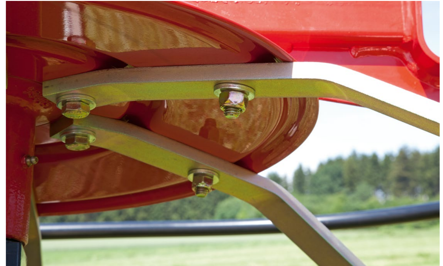
Breite Auflagefläche für eine optimale Kraftübertragung
